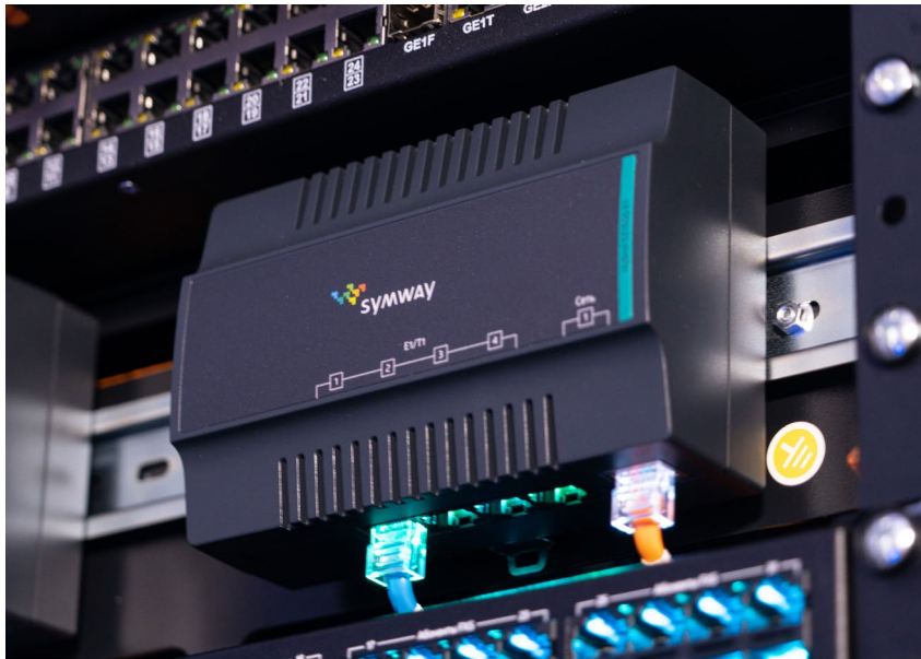
Symway Hybrid SZ1900 E1 на DIN-рейке в серверном шкафу.
