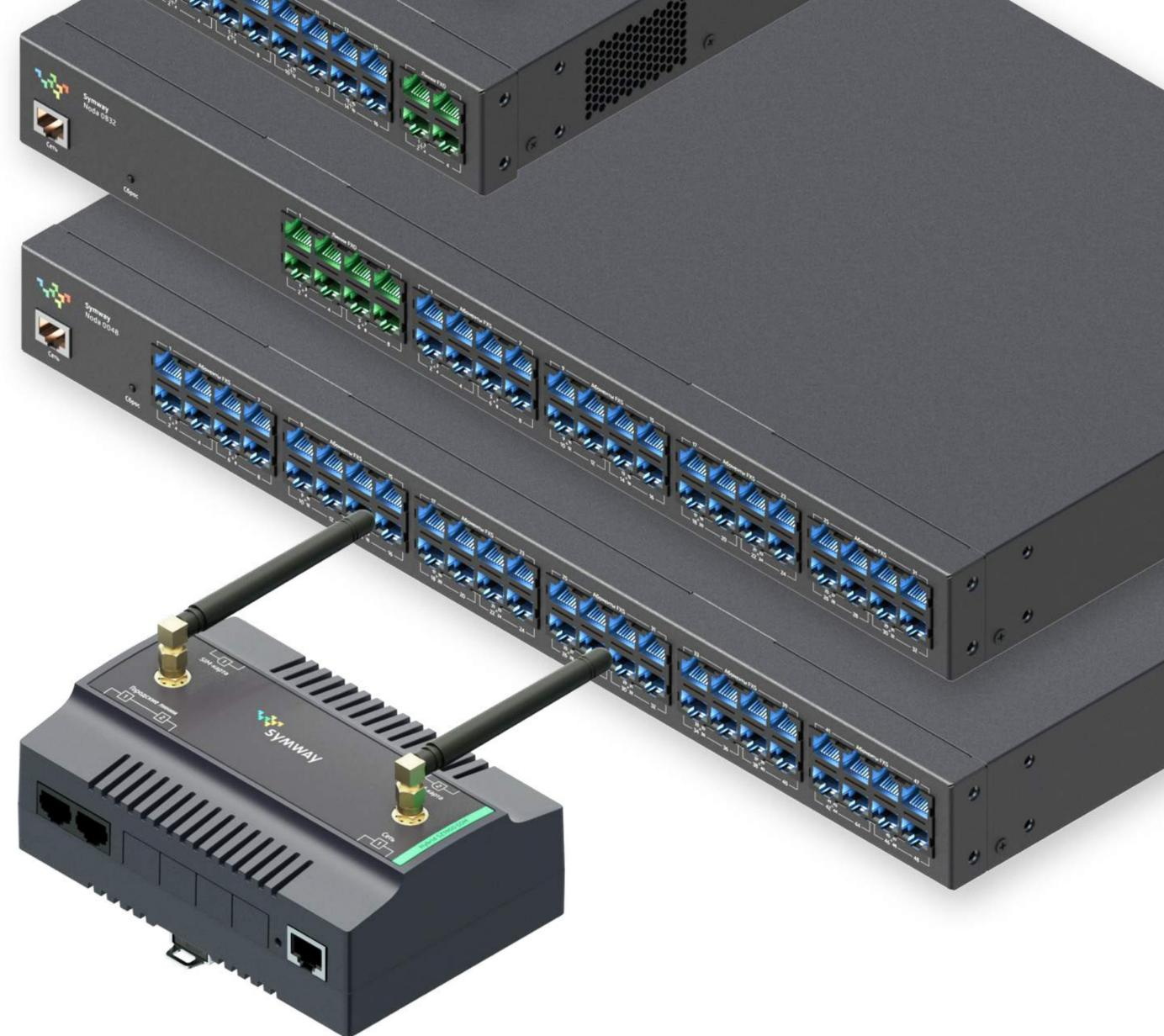
Устройства отличаются типами портов подключения к внешним сетям и абонентским терминалам (FXO, FXS, GSM, E1) и их количеством.
